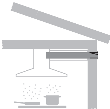
Con canale di scarico laterale visibile
