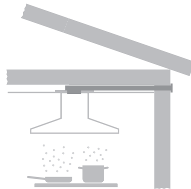
Con canale di scarico nascosto, ad es. in un controsoffitto con condotta dell'aria di scarico in canale piatto
